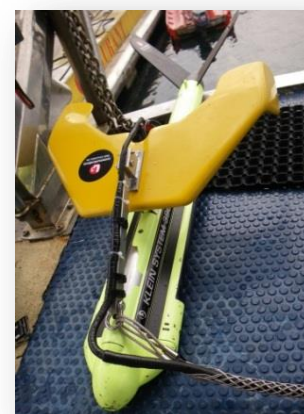
Poisson tracté du sonar latéral Klein 3900. Photo : E. Charbonnel/PMCB.
