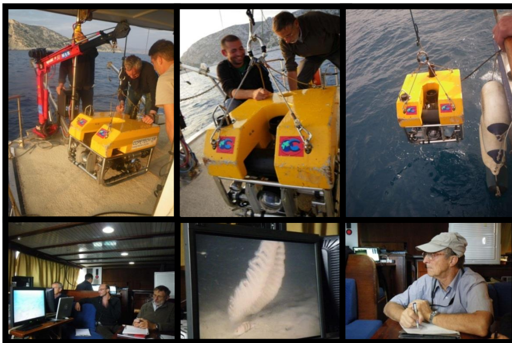
Figure 18 : Mise en œuvre du ROV Achille M4 de la société COPETECH SM. Taille : 720 x 600 x 510 mm ; Poids 120 kg (mise à l'eau et immersion, visualisation embarquée, inventaire des experts en temps réel). Photos : E. Charbonnel/PMCB.
